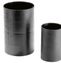
Doppelsteckmuffe (2707) Zum Anschluss und zur Verlän- gerung der Kabelschutzrohre (2775). Nicht geeignet für biege- steife Mantelrohre
